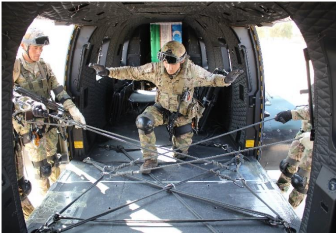
1-rasm. Vertolyotning yon tomonidagi eshiklardan tezkor tushish uchun tayanch nuqtalarini tayyorlashda pol qismidagi shvartovka qilish uskunalari va tushish moslamalaridan foydalanish
